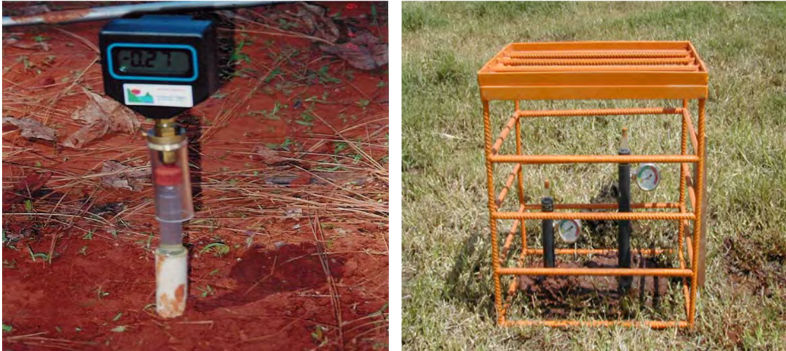
FIGURA 27 – Tensiômetros digital e o analógico instalado na pastagem com gaiola de proteção.
