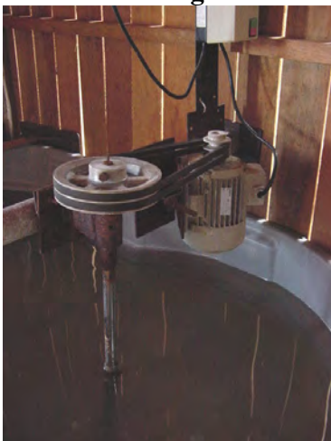
FIGURA 25D - Detalhe do misturador, feito com um motor de ½ CV de baixa rotação.
