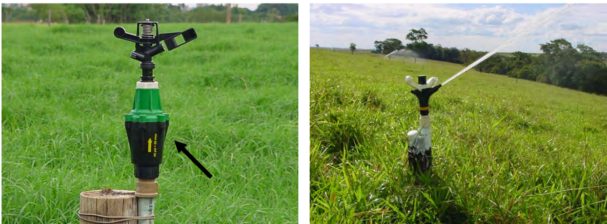
FIGURA 11 – Aspersão com regulador de pressão e mini-canhão em funcionamento.
