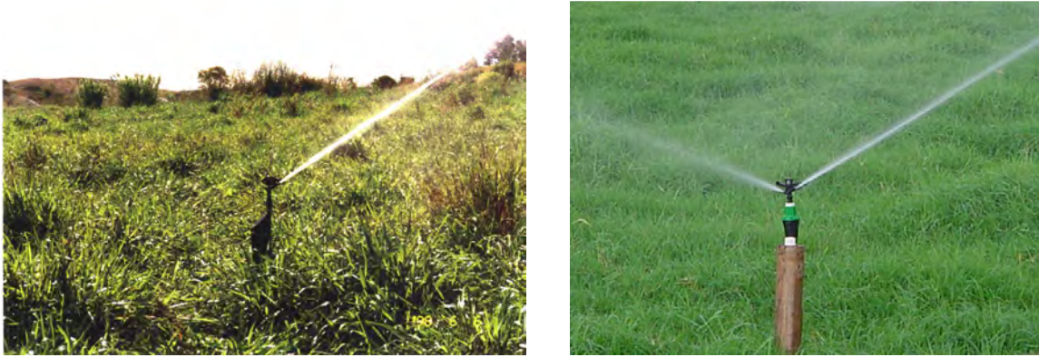
FIGURA 7 - Aspersores de um e dois bocais, com regulador de pressão.
