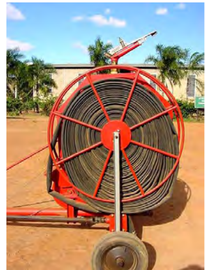
FIGURA 20 – Autopropelido tracionado pela própria mangueira de polietileno e por cabo de aço (mais antigo).
