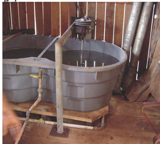
FIGURA 25D - Detalhe do misturador, feito com um motor de ½ CV de baixa rotação.
