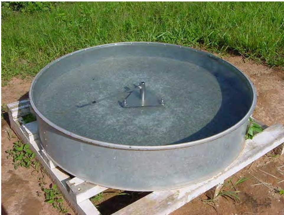
FIGURA 26 – Tanque Classe A.
