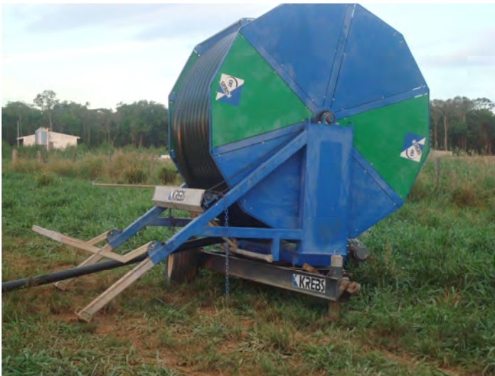
FIGURA 20 – Autopropelido tracionado pela própria mangueira de polietileno e por cabo de aço (mais antigo).
