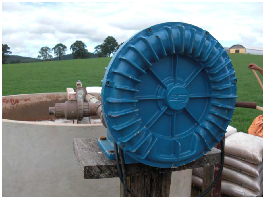
FIGURA 25F: Turbina de ar para solubilização do fertilizante.
